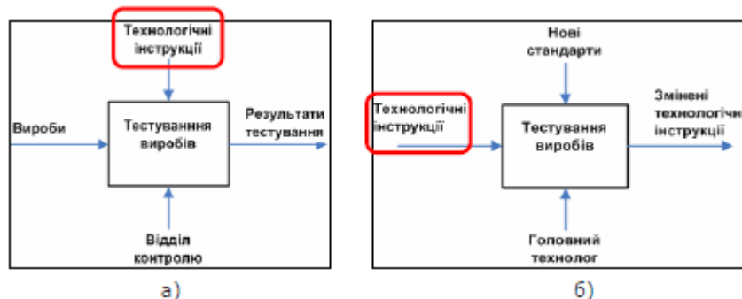
Рис. 4.2. Приклад інтерфейсної дуги, що управляє (а), що входить (б)
