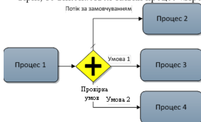
Рис. 5.3. Використання ексклюзивного шлюзу для розгалуження потоків управління
